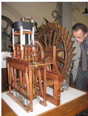
La machine élévatoire se compose d'une roue à aubes mue par l'énergie hydraulique provenant d'une dérivation du Grand Canal, entraînant deux groupes de trois corps de pompes par un système de balanciers, manivelles et bielles.
