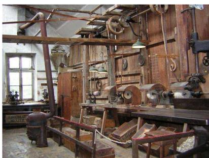
Au système composé de roues dentées et d'arbres de transmission hérité des mécanismes utilisés dans les vieux moulins ont été ajoutées des poulies et courroies servant à actionner les différentes machines de l'usine. Ce système est capital pour la transmissions de l'énergie hydraulique jusqu'aux points d'utilisation des machines dans l'usine.
