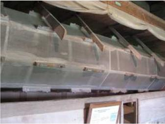
Disposées au premier niveau, sous les meules, deux bluteries de grande taille distribuent les farines. Les sons étant acheminés par des conduits verticaux, directement au rez de chaussée.
