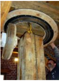
l'arbre en chêne descend du 3ème étage, de la couronne du tire-sacs au travers de la lanterne
