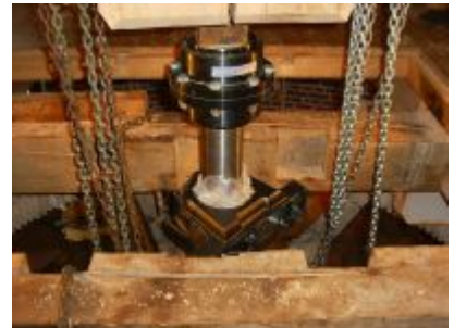
Les détails et le montage de l'accouplement entre l'arbre de lanterne et l'arbre du hérisson (permettant un alignement "souple" des deux arbres).
