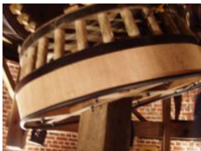
la lanterne est descendue le long de l'arbre vertical à l'aide d'un câble
