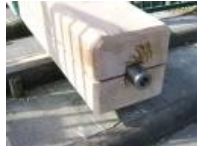
l'arbre en chêne descend du 3ème étage, de la couronne du tire-sacs au travers de la lanterne
