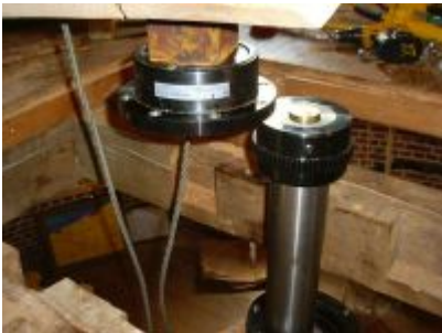
Les détails et le montage de l'accouplement entre l'arbre de lanterne et l'arbre du hérisson (permettant un alignement "souple" des deux arbres).
