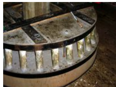
la lanterne glisse le long de l'arbre vertical et vient reposer sur la plancher du 3ème étage
