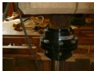
l'arbre de hérisson est hissé au premier étage et va être inséré dans le hérisson posé sur les coffres des meules
