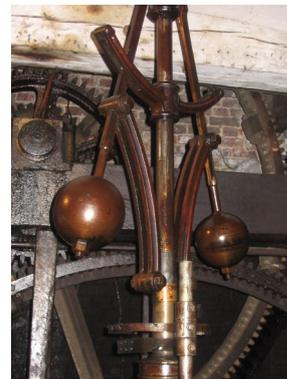
En parfait état de marche et fonctionnant douze heures par jour, il reste l'un des rares exemples en France de régulateur de moulin hydraulique fonctionnant sur le principe de la force centrifuge.
